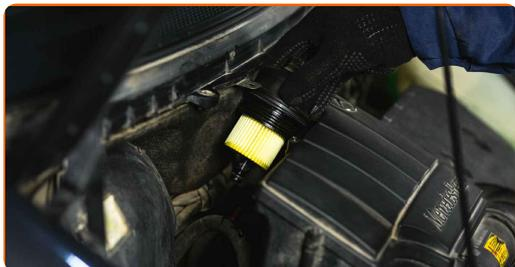
**19.2** Verwenden Sie Stecknuss Nr. 27. Verwenden Sie einen Drehmomentschlüssel. Ziehen Sie ihn mit 25 Nm Drehmoment fest.
