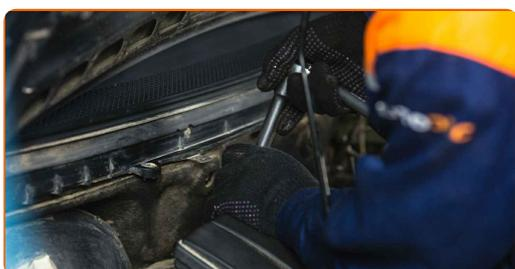
**20** Schrauben Sie die Öleinfüllschraube ab.
