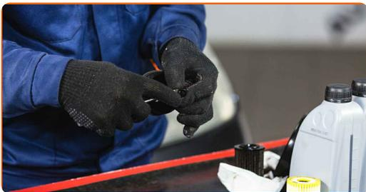
**16** Setzen Sie neue O-Ringe (2 Stück) sowie einen neuen Ölfilter in deren Aufnahmen an der Filterabdeckung ein. Verwenden Sie einen flachen Schraubendreher.
