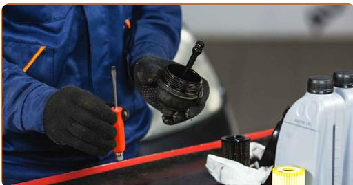
**15.1** Entfernen Sie die alten O-Ringe aus dem Ölfilterdeckel.
