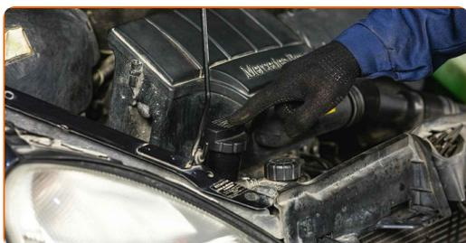
**21** Entfernen Sie die Öleinfüllschraube.
