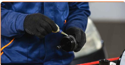
**18** Reinigen Sie die Ölfilteraufnahme.
