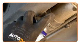
Schrauben Sie die Befestigungsbolzen der Treibstofffilterhalterung ab. Verwenden Sie Stecknuss Nr. 8. Verwenden Sie einen Ratschenschlüssel.
