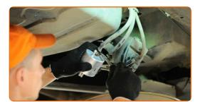
Installieren Sie einen neuen Kraftstofffilter.
