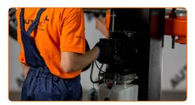
Reinigen Sie die Kraftstoff-Filterhalterung. Benutzen Sie eine Drahtbürste. Benutzen Sie WD-40-Spray.
