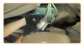
Lockern Sie die Befestigungsklemme der Kraftstofffilterleitung. Verwenden Sie Stecknuss Nr. 7. Verwenden Sie einen Ratschenschlüssel.
