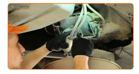
Lösen Sie die Schläuche vom Kraftstofffilter. Verwenden Sie einen flachen Schraubendreher.
