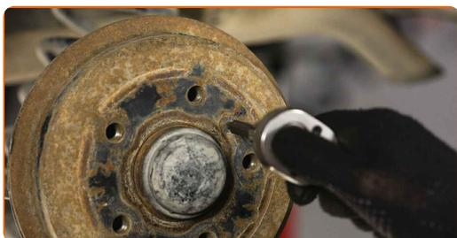
**9** Entfernen Sie die Bremstrommel. Verwenden Sie einen Gummi-Hammer.
