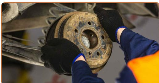
**10** Entfernen Sie die Schutzkappe des Nabenlagers. Verwenden Sie einen flachen Schraubendreher.
