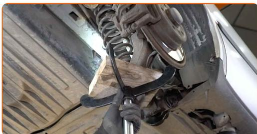
**10** Schrauben Sie den unteren Befestiger des Stoßdämpfers ab. Verwenden Sie Ring-Gabelschlüssel Nr. 18. Verwenden Sie Stecknuss Nr. 18. Verwenden Sie ein Windeisen.
