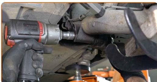
**11** Entfernen Sie die Befestigungsschraube.
