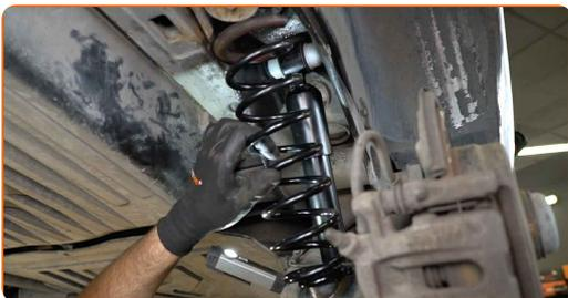
**17** Stützen Sie die Verbundlenkerachse. Benutzen Sie einen hydraulischen Getriebeheber.
