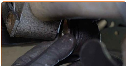
**13** Die Montage unter dem Hinterachsträger entfernen.
