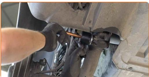
**21** Heben Sie den hydraulischen Getriebeheber um 10–15 cm an.
