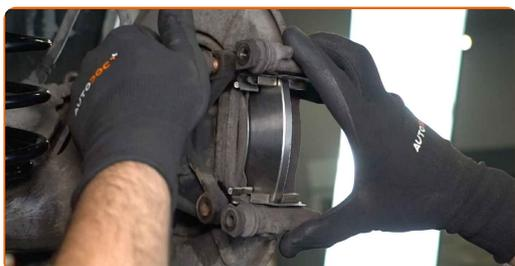
**23** Befestigen Sie die Bremssattelhalterung. Verwenden Sie Stecknuss Nr. 16. Verwenden Sie einen Drehmomentschlüssel. Ziehen Sie ihn mit 55 Nm Drehmoment fest.
