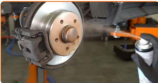
**29** Die Bremsscheibenoberfläche reinigen. Benutzen Sie einen Bremsenreiniger.
