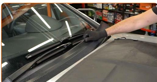
**23** Entfernen Sie die Kotflügel-Abdeckung.
