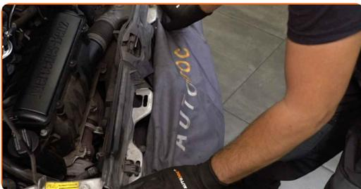
**3** Schrauben Sie die Befestigung der Windlaufabdeckung auf. Verwenden Sie einen Kreuzschlitzschraubendreher.
