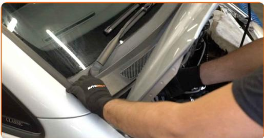
**5** Entfernen Sie die Abdeckungen der Frontscheibenwischerarmmutter.
