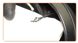
Lösen Sie den Halteclip für das Spiegelglas. Verwenden Sie einen flachen Schraubendreher.
