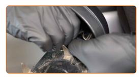
Behandeln Sie die Steckverbindungen der Spiegelheizung. Verwenden Sie dielektrisches Fett.
