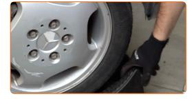
42 Entfernen Sie die Kotflügel-Abdeckung.
