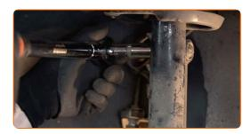
Entfernen Sie den Träger unter dem Achsschenkel.
