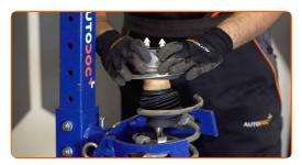
Ziehen Sie die Federbeinkolbenstangenmutter an. Verwenden Sie Stecknuss Nr. 19. Verwenden Sie Inbusschlüssel Nr. H7. Verwenden Sie einen Drehmomentschlüssel. Ziehen Sie ihn mit 60 Nm Drehmoment fest.
