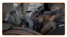
Ziehen Sie die unteren Befestigungen an, die das Federbein mit dem Achsschenkel verbinden. Verwenden Sie Stecknuss Nr. 18. Verwenden Sie Ring-Gabelschlüssel Nr. 18. Verwenden Sie einen Drehmomentschlüssel. Ziehen Sie ihn mit 100 Nm Drehmoment fest.
