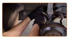
Schrauben Sie die Mutter ab und entfernen Sie die Stabilisatorstange aus dem Federbein. Verwenden Sie Ring-Gabelschlüssel Nr. 16.
