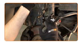
Befestigen Sie die Stabilisatorverbindung am Federbein. Verwenden Sie Stecknuss Nr. 16. Verwenden Sie einen Drehmomentschlüssel. Ziehen Sie ihn mit 45 Nm Drehmoment fest.
