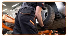
Reinigen Sie die Befestigungselemente, welche den Stabilenker mit dem Federbein verbinden, sowie die, welche das Federbein mit dem Achsschenkel verbinden. Benutzen Sie eine Drahtbürste.
