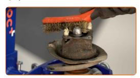
Entfernen Sie die Stangenmutter des Federkolben. Verwenden Sie Ring-Gabelschlüssel Nr. 19. Verwenden Sie Inbusschlüssel Nr. H7. Verwenden Sie einen Ratschenschlüssel.
