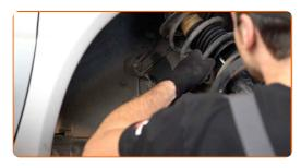
Sichern Sie die oberen Befestigungen des Federbeines. Verwenden Sie Stecknuss Nr. E12. Verwenden Sie einen Ratschenschlüssel. Schrauben Sie diese nicht fest.
