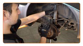
Schrauben Sie die untere Befestigung der Stoßdämpferstrebe ab. Verwenden Sie Stecknuss Nr. E12.
