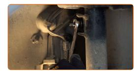
Schrauben Sie das untere Befestigungselement ab, dass das Federbein mit dem Achsschenkel verbindet. Verwenden Sie Stecknuss Nr. 18. Verwenden Sie Ring-Gabelschlüssel Nr. 18. Verwenden Sie einen Ratschenschlüssel. Verwenden Sie ein Windeisen.
