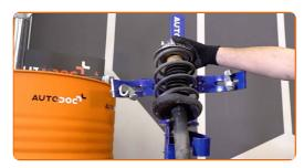
Installieren Sie das Federbein am Radlauf.
