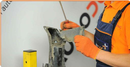
**14** Behandeln Sie die Federbeinstange. Benutzen Sie eine Drahtbürste. Benutzen Sie WD-40-Spray.
