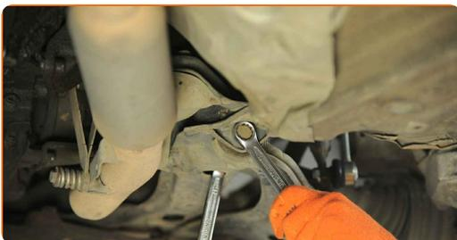
**12** Lösen Sie die hintere Befestigung des Querlenkers.
