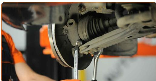
**8** Entfernen Sie die Befestigungsschraube.
