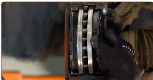
Austausch: Bremsbeläge – Honda Accord VIII CU. Tipp von AUTODOC:
