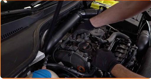
**5** Heben Sie ein wenig die Verkabelung der Zündspulen an und legen Sie sie zur Seite.
