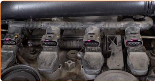
**6** Heben Sie die Zündspule an (4 Stück). Benutzen Sie ein Brecheisen.
