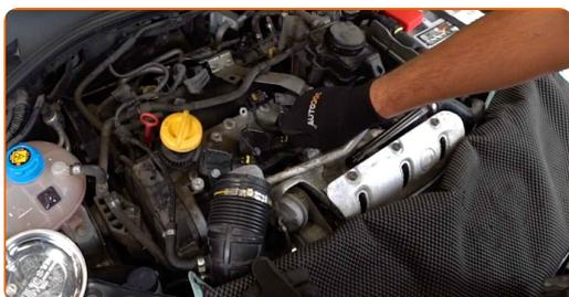
**16** Heben Sie ein wenig die Verkabelung der Zündspulen an und legen Sie sie zur Seite.
