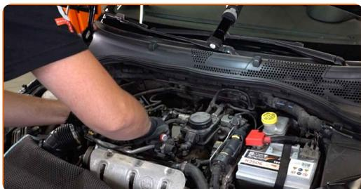
**17** Schrauben Sie die Zündspulenklammer ab. Verwenden Sie Stecknuss Nr. 10.
