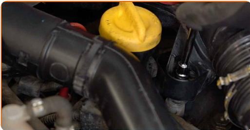
**6** Trennen Sie das Luftansaugrohr vom Luftfilter-Gehäuse.
