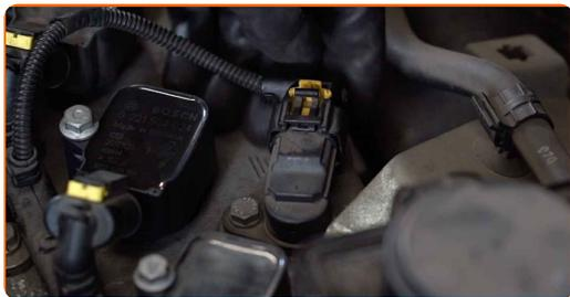
**14** Schrauben Sie das Verbindungselement des Karosserie-Terminals (Erdung) der Zündspulen ab. Verwenden Sie Stecknuss Nr. 10.
