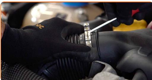
**4** Lösen Sie die Kurbelgehäuse-Entlüftungsschlauchklemme. Verwenden Sie einen flachen Schraubendreher.
