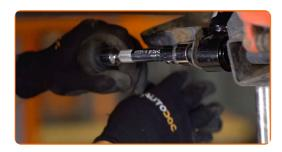
Ziehen Sie die obere Stoßdämpferbefestigung an. Verwenden Sie Stecknuss Nr. 19. Verwenden Sie einen Drehmomentschlüssel. Ziehen Sie ihn mit 80 Nm Drehmoment fest.
