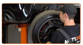
6 Stützen Sie den Arm. Benutzen Sie einen hydraulischen Getriebeheber.
