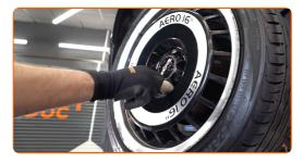
Senken Sie das Auto und ziehen Sie die Radschrauben über Kreuz an. Verwenden Sie einen Drehmomentschlüssel. Ziehen Sie ihn mit 110 Nm Drehmoment fest.
