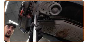
Schrauben Sie das obere Befestigungselement des Stoßdämpfers ab. Verwenden Sie Stecknuss Nr. 19. Verwenden Sie ein Windeisen.
