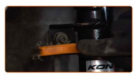
Schrauben Sie die Mutter ab und entfernen Sie die Stabilisatorstange aus dem Federbein. Benutzen Sie den Ringschlüssel #18. Verwenden Sie Stecknuss Nr. 18. Verwenden Sie Inbusschlüssel Nr. H5.
