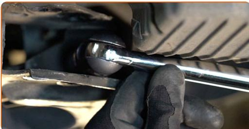
**30** Schrauben Sie die hintere Armbefestigung ab. Verwenden Sie Stecknuss Nr. 18. Verwenden Sie ein Windeisen.
