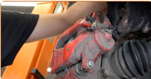
24 Verbinden Sie die ABS-Sensor Steckdose. Verbinden Sie den Stecker des Verschleißsensors der Bremsbeläge.
