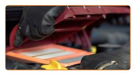
5 Entfernen Sie das Filterelement aus dem Filtergehäuse.
