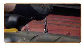
11 Entfernen Sie die Kotflügel-Abdeckung.
