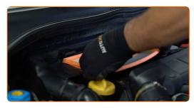
Bedecken Sie die Ansaugkrümmer-Kanäle mit einem Mikrofasertuch, um zu verhindern, dass Staub und Schmutz eindringen.
