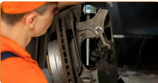
59 Schrauben Sie die Befestigung der Pendelstützenhalterung fest. Verwenden Sie Stecknuss Nr. 16 Verwenden Sie einen Ratschenschlüssel. Verwenden Sie einen Drehmomentschlüssel. Ziehen Sie ihn mit 65 Nm Drehmoment fest.
