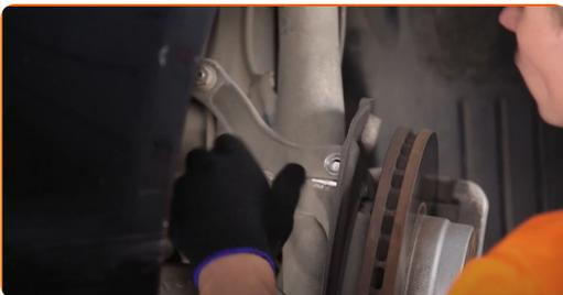
17 Reinigen Sie die Befestigungselemente, die den Querlenker mit dem Hilfsrahmen verbinden. Benutzen Sie eine Drahtbürste. Benutzen Sie WD-40-Spray.
