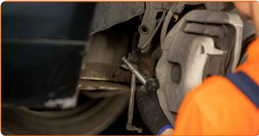
16 Entfernen Sie die Halterung der Stoßdämpferstrebe.
