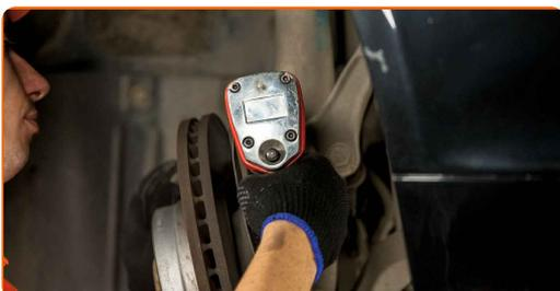
12 Entfernen Sie die Befestigungsschraube.
