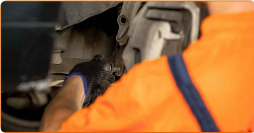
15 Entfernen Sie die Befestigungsschraube.
