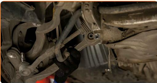
55 Installieren Sie das hintere Befestigungselement des Querlenkers.
