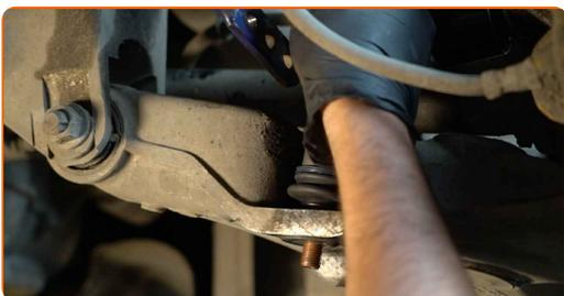
**12** Ziehen Sie die Befestigungselemente des Stabilenkers fest. Verwenden Sie Ring-Gabelschlüssel Nr. 15. Verwenden Sie Ring-Gabelschlüssel Nr. 17. Verwenden Sie Ring-Gabelschlüssel Nr. 18. Verwenden Sie Inbusschlüssel Nr. H6. Verwenden Sie einen Ratschenschlüssel.
