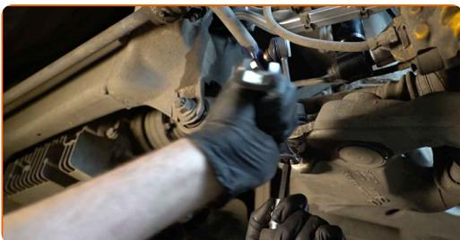
**13** Ziehen Sie das Befestigungselement an, das den Stabilisator mit dem Querlenker verbindet. Verwenden Sie Stecknuss Nr. 18. Verwenden Sie einen Drehmomentschlüssel. Ziehen Sie ihn mit 100 Nm Drehmoment fest.
