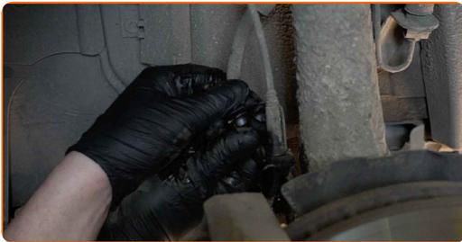
**13** Reinigen Sie die Befestigungen des Sensors der Leuchtweitenregulierung. Benutzen Sie eine Drahtbürste. Benutzen Sie WD-40-Spray.
