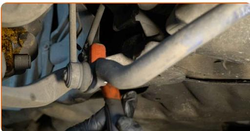
**14** Schrauben Sie die Befestigungen des Sensors der Leuchtweitenregulierung ab. Verwenden Sie Ring-Gabelschlüssel Nr. 10.
