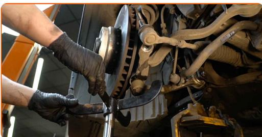
**31** Lösen Sie die hintere Befestigung des Querlenkers. Verwenden Sie Ring-Gabelschlüssel Nr. 18.
