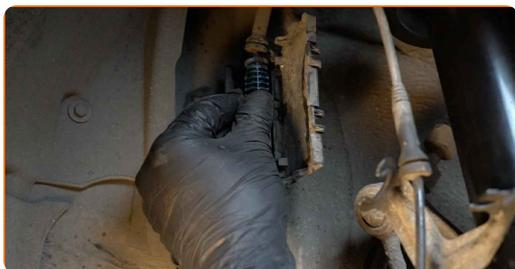
**85** Schließen Sie den Sensor der Leuchtweitenregulierung wieder an.
