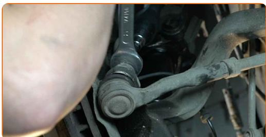
**81** Reinigen Sie die Montagesitze der Koppelstange. Benutzen Sie eine Drahtbürste. Benutzen Sie WD-40-Spray.
