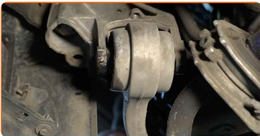
**35** Die Befestigungselemente, die das Federbein mit dem Achsschenkel verbinden, reinigen. Benutzen Sie eine Drahtbürste. Benutzen Sie WD-40-Spray.
