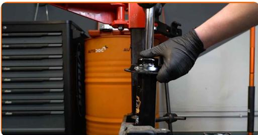
**53** Installieren Sie die Staubschutzmanschette und den Anschlagpuffer auf dem neuen Stoßdämpfer.
