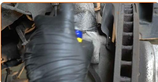
**36** Entfernen Sie die Befestigungsschraube.
