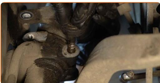
**37** Lösen Sie das untere Befestigungselement, dass das Federbein mit dem Achsschenkel verbindet. Verwenden Sie einen flachen Metallmeißel. Benutzen Sie einen Hammer.
