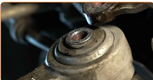
**33** Entfernen Sie die vordere Befestigung des Querlenkers. Verwenden Sie Ring-Gabelschlüssel Nr. 18.
