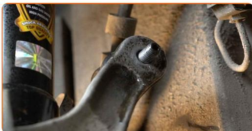
**83** Ziehen Sie die Befestigungselemente des Stabilenkers fest. Verwenden Sie Ring-Gabelschlüssel Nr. 16. Verwenden Sie den Torx T30. Verwenden Sie einen Ratschenschlüssel.
