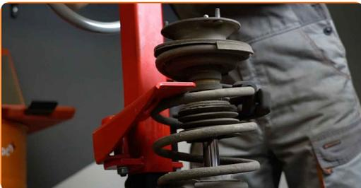
**44** Entfernen Sie die Kappe des Federbeinstützlagers. Benutzen Sie ein Brecheisen.
