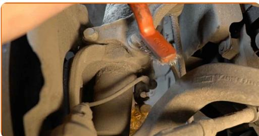
**17** Schrauben Sie das Befestigungselement heraus, das die Druckstange mit dem Federbein verbindet. Verwenden Sie Ring-Gabelschlüssel Nr. 16. Verwenden Sie den Torx T30. Verwenden Sie einen Ratschenschlüssel.
