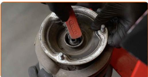
**46** Entfernen Sie die Stangenmutter des Federkolben. Verwenden Sie Stecknuss Nr. 21. Verwenden Sie Inbusschlüssel Nr. H7. Verwenden Sie einen Ratschenschlüssel.
