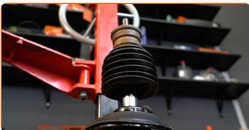
**54** Installieren Sie die Feder am Stoßdämpfer.
