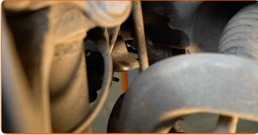
**16** Die Befestigungselemente, die das Federbein mit dem Achsschenkel verbinden, reinigen. Reinigen Sie die Befestigungen der Koppelstange. Benutzen Sie eine Drahtbürste. Benutzen Sie WD-40-Spray.
