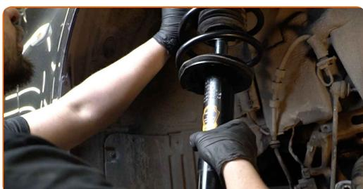
**64** Schrauben Sie die obere Befestigung des Domlagers an. Schrauben Sie diese nicht fest.
