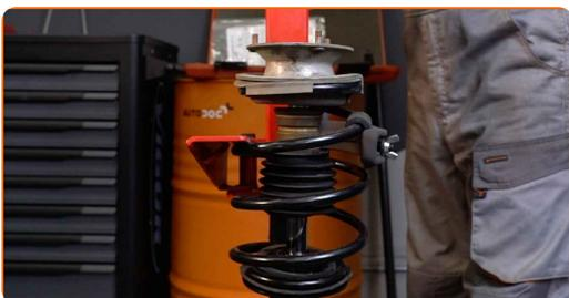
**61** Entfernen Sie das zusammengebaute Federbein.
