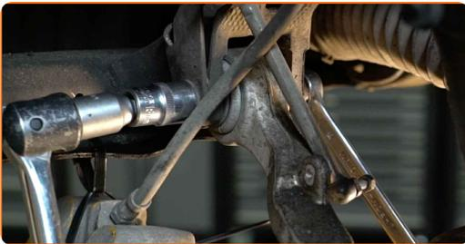
**28** Schrauben Sie die vordere Armbefestigung ab. Verwenden Sie Ring-Gabelschlüssel Nr. 18. Verwenden Sie Stecknuss Nr. 18. Verwenden Sie einen Ratschenschlüssel.
