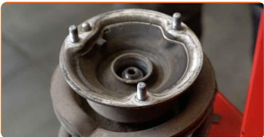
**45** Behandeln Sie die Federbeinstange. Benutzen Sie eine Drahtbürste. Benutzen Sie WD-40-Spray.
