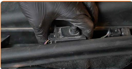
**18** Befestigen Sie die Clips der Innenraumfilterabdeckung.
