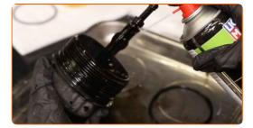
Installieren Sie einen neuen Dichtungsring an seinem Montagesitz auf der Filterabdeckung.
