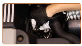
Bauen Sie die Abdeckung des Ölfiltergehäuses ein und schrauben Sie diese ein. Verwenden Sie Stecknuss Nr. 36. Verwenden Sie einen Drehmomentschlüssel. Ziehen Sie ihn mit 25 Nm Drehmoment fest.
