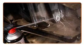
Schrauben Sie die neue Ablassschraube ein und ziehen Sie sie fest. Verwenden Sie Stecknuss Nr. 19. Verwenden Sie einen Drehmomentschlüssel. Ziehen Sie ihn mit 25 Nm Drehmoment fest.
