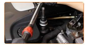
Entfernen Sie die Öleinfüllschraube.
