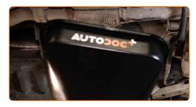
Reinigen Sie den Bereich um die Ablassöffnung der Ölwanne. Benutzen Sie eine Drahtbürste. Verwenden Sie 10 Allzweckreinigungsspray.
