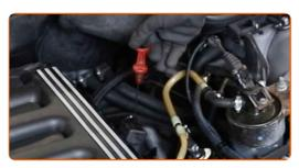
Reinigen Sie den Deckel des Ölfilter-Gehäuses. Verwenden Sie Allzweckreinigungsspray.
