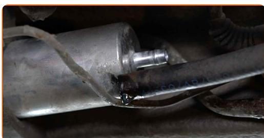
**10** Entfernen Sie den Stecker der Kraftstoffpumpe.
