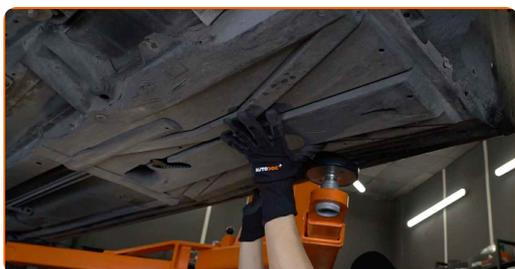
**23** Schrauben Sie die Befestigungen der Kunststoffschutzabdeckung der Karosserie ein. Verwenden Sie Stecknuss Nr. 8. Verwenden Sie Stecknuss Nr. 10. Verwenden Sie einen Kreuzschlitzschraubendreher. Verwenden Sie einen Ratschenschlüssel.
