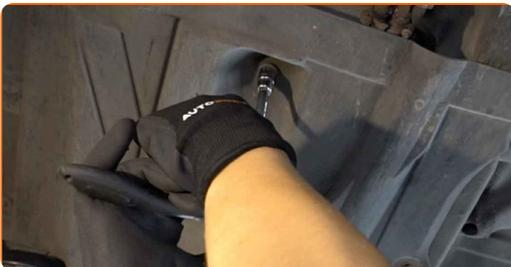
**4** Entfernen Sie die Kunststoffschutzabdeckung der Karosserie.
