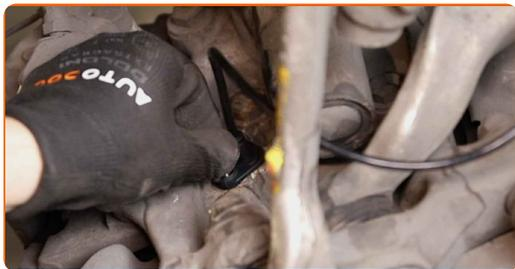
**14** Schrauben Sie die Befestigung, die den ABS-Sensor am Achsschenkel verbindet, fest. Verwenden Sie Stecknuss Nr. 10. Verwenden Sie einen Drehmomentschlüssel. Ziehen Sie ihn mit 7 Nm Drehmoment fest.
