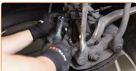
**15** Verbinden Sie das ABS mit der Sensorverdrahtung.
