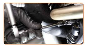
Bringen Sie den Kühlmittelschlauch an.
