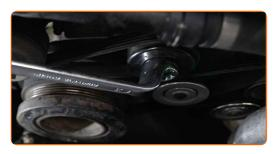
Entfernen Sie den Keilrippenriemen.
