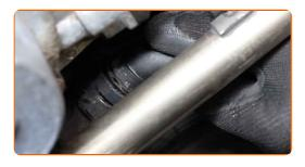
Lockern Sie die Klemme des Kühlmittelschlauchs.
