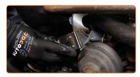
Behandeln Sie den Montagesitz des Thermostatgehäuses. Verwenden Sie ein Dichtmittel.
