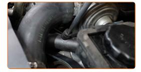
Entfernen Sie den Deckel des Kühlmittelbehälters.
