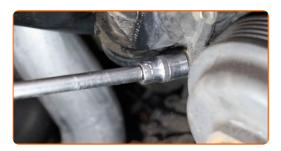
Entfernen Sie das Thermostatgehäuse. Benutzen Sie ein Brecheisen.
