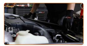
Schrauben Sie den Deckel des Kühlmittelbehälters ab.
