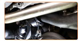
Ziehen Sie die Schelle des Kühlmittelschlauchs fest. Verwenden Sie Stecknuss Nr. 10. Verwenden Sie einen Drehmomentschlüssel. Ziehen Sie ihn mit 6 Nm Drehmoment fest.
