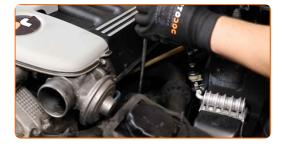
Bringen Sie den Kühlmittelschlauch an.
