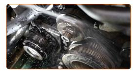
Ziehen Sie die Spannrolle des Keilrippenriemens beiseite. Verwenden Sie Ring-Gabelschlüssel Nr. 26.
