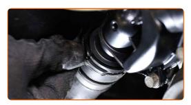
Reinigen Sie die Montagesitze des Keilrippenriemens. Verwenden Sie Allzweckreinigungsspray.
