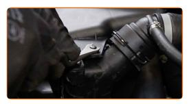
Schrauben Sie die Befestigung des Kühlgebläses ab. Verwenden Sie Ring-Gabelschlüssel Nr. 32 (2 Teile).
