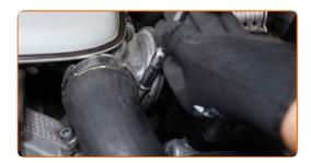
Entfernen Sie den Schlauch des Ladeluftkühler.
