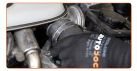
Schrauben Sie die Befestigung der Klemme des Kühlmittelschlauchs ab. Verwenden Sie Stecknuss Nr. 10. Verwenden Sie einen Ratschenschlüssel.
