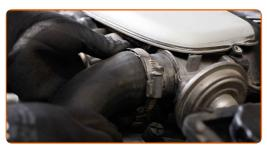
Schrauben Sie die Klemme des Ladeluftkühlerschlauchs an. Verwenden Sie Stecknuss Nr. 7. Verwenden Sie einen Ratschenschlüssel.
