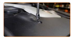
Entfernen Sie die Kotflügel-Abdeckung.
