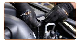
Schrauben Sie die Ablassschraube des Kühlsystems ab. Verwenden Sie einen flachen Schraubendreher.
