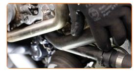
36 Sichern Sie die Klemme des Kühlmittelschlauchs.
