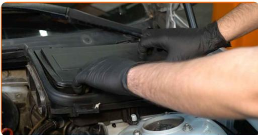
**5** Entfernen Sie den Gehäusedeckel des Innenraumfilters.
