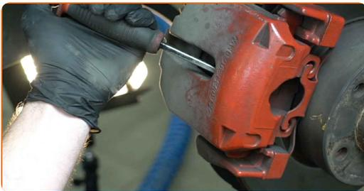
**17** Lösen Sie die Bremssattel-Haltefeder. Benutzen Sie ein Brecheisen.
