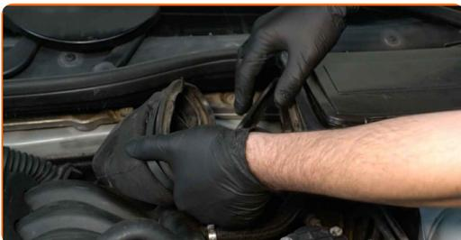
**4** Lösen Sie die Clips der Innenraumfilterabdeckung.
