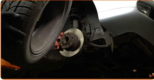
**14** Entfernen Sie die Staubschutzkappen der Bremssattel-Führungsstifte. Benutzen Sie ein Brecheisen.
