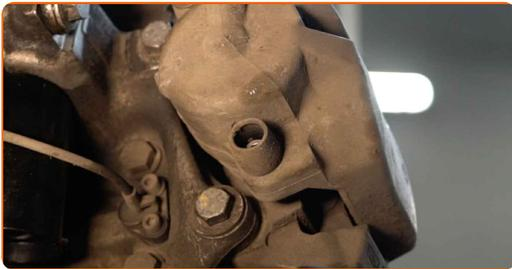
**15** Schrauben Sie die Befestigung des Bremssattels ab. Verwenden Sie Inbusschlüssel Nr. H7. Verwenden Sie einen Ratschenschlüssel.
