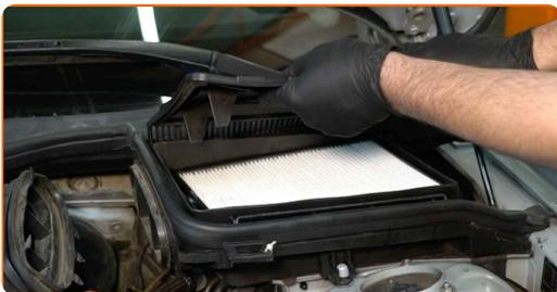
**6** Entfernen Sie die Abdichtung des Mikrofilterkastens.
