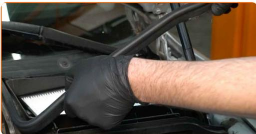
**7** Entfernen Sie das Luftfiltergehäuse.
