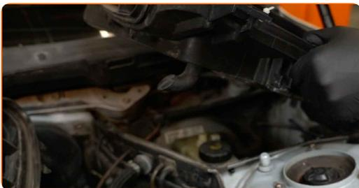
**8** Schrauben Sie die Kappe des Bremsflüssigkeitsausgleichsbehälters ab.
