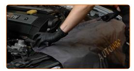
Lösen Sie die Befestigungsclips der Luftfilterabdeckung.
