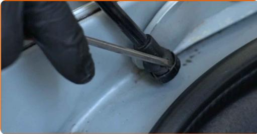
**Austausch: Heckklappendämpfer – BMW E39. Tipp von AUTODOC-Experten:**
