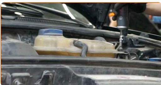
**33** Entfernen Sie die Kotflügel-Abdeckung.
