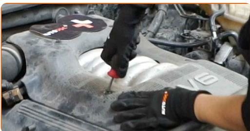
**29** Setze die Komponenten des Lüftungskanals wieder ein.
