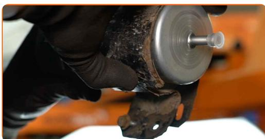
**15** Installieren Sie einen neuen Kraftstofffilter.
