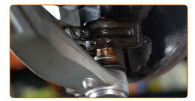
Schrauben Sie das Befestigungselement ein, das das Kugelgelenk mit dem Achsschenkel verbindet. Verwenden Sie Ring-Gabelschlüssel Nr. 18.
