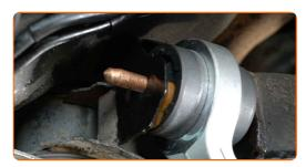
Schrauben Sie das Befestigungselement ein, das den Querlenker mit dem Hilfsrahmen verbindet. Verwenden Sie Ring-Gabelschlüssel Nr. 18.
