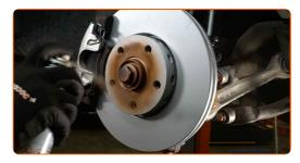
Die Bremsscheibenoberfläche reinigen. Benutzen Sie einen Bremsenreiniger.
