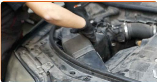
**19** Schraube die Befestigungselemente des Lüftungskanals ein. Verwenden Sie einen Kreuzschlitzschraubendreher.
