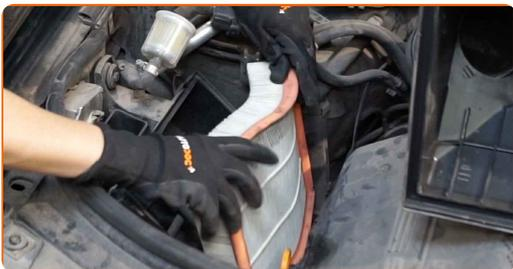
**10** Bedecken Sie den Luftansaugschlauch mit einem Mikrofaser Tuch, um zu vermeiden, dass Staub und Schmutz in das System gelangen.
