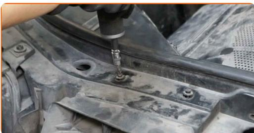
**20** Bauen Sie die Abdeckung des Luftfiltergehäuses ein.
