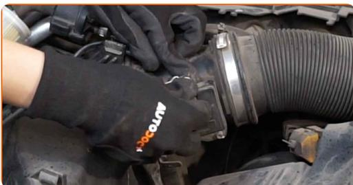
**18** Setze die Komponenten des Lüftungskanals wieder ein.
