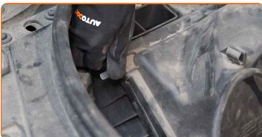
**8** Heben Sie die Abdeckung des Luftfiltergehäuses leicht an.
