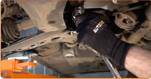
8 Lösen Sie das Befestigungselement, welches das Kugelgelenk am Federungsquerlenker befestigt. Verwenden Sie Stecknuss Nr. 13. Verwenden Sie ein Windeisen.
