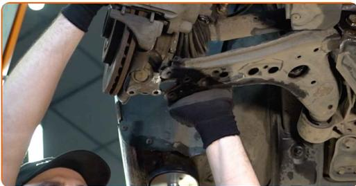
10 Entfernen Sie die vordere Befestigung des Querlenkers. Verwenden Sie Stecknuss Nr. 18.
