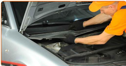
**30** Bauen Sie die Dichtung der Windabweiserabdeckung ein.
