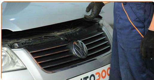
**33** Heben Sie die Vorderseite des Autos und sichern auf Stützen.
