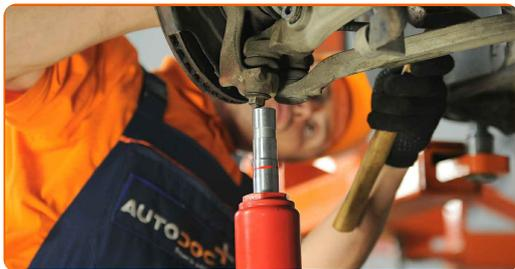
**37** Ziehen Sie die Befestigungsschraube an, die die Stoßdämpfergabel mit dem unteren Querlenker verbindet. Verwenden Sie Ring-Gabelschlüssel Nr. 18. Verwenden Sie Stecknuss Nr. 18. Verwenden Sie einen Drehmomentschlüssel. Ziehen Sie ihn mit 90 Nm Drehmoment fest.
