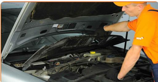
**14** Entfernen Sie die Kappe des Federbeinstützlagers. Verwenden Sie einen flachen Schraubendreher.
