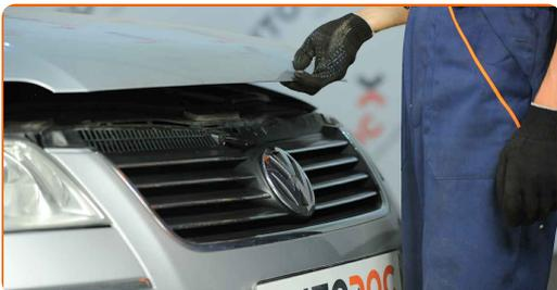
**11** Verwenden Sie eine Kotflügel-Schutzabdeckung, um Schäden an der Lackierung und den Kunststoffteilen des Autos zu verhindern.
