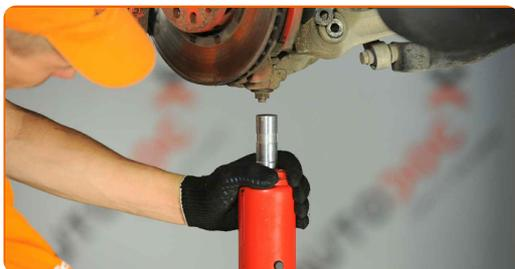
**35** Bringen Sie die Befestigungsschraube an. Verwenden Sie einen Splintentreiber. Benutzen Sie einen Hammer.
