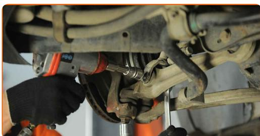
**38** Entfernen Sie den Träger unter dem Arm.
