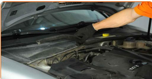
**13** Heben Sie die Windabweiserabdeckung an und entfernen Sie dieses.
