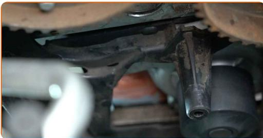
**65** Schrauben Sie die Befestigungen der mittleren Zahnriemenabdeckung ein. Verwenden Sie Stecknuss Nr. 8. Verwenden Sie einen Ratschenschlüssel.
