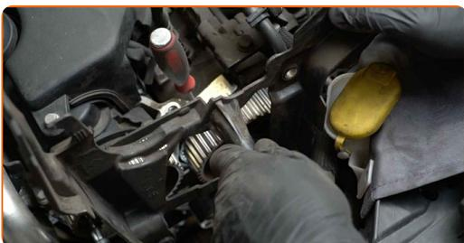
**51** Lösen Sie die Klemme der unteren Kühlmittleitung. Verwenden Sie die Lange Rundzange.
