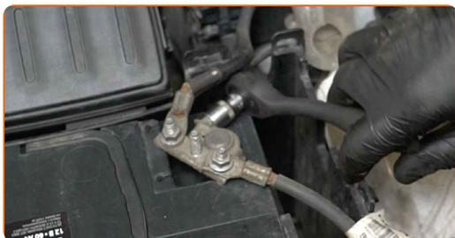
**4** Entfernen Sie die Batterieklemmen.
