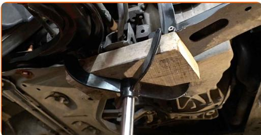
**20** Reinigen Sie die Befestigungen des Hilfsrahmens. Benutzen Sie eine Drahtbürste. Benutzen Sie WD-40-Spray.
