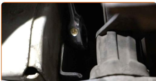
**15** Entfernen Sie den Befestigungswinkel des Kraftstofffilters.
