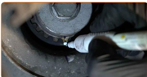
**42** Lockern Sie die Befestigung der Spannrolle des Zahnriemens. Verwenden Sie Ring-Gabelschlüssel Nr. 13. Verwenden Sie Inbusschlüssel Nr. H6.
