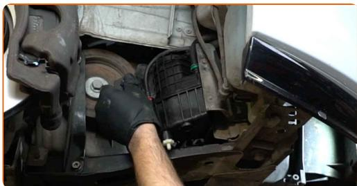
**16** Ziehen Sie die Spannrolle des Keilrippenriemens beiseite. Verwenden Sie Ring-Gabelschlüssel Nr. 16.
