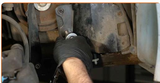
**13** Entfernen Sie den Befestigungswinkel des Kraftstofffilters.
