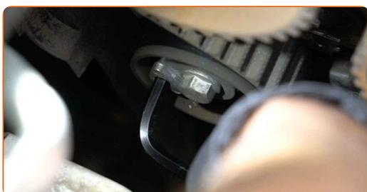
**43** Ziehen Sie die Spannrolle des Zahnriemens beiseite.
