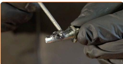
**61** Bauen Sie die Wasserpumpendichtung ein.
