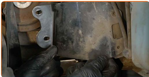
**14** Schrauben Sie die Befestigungsbolzen der Treibstofffilterhalterung ab. Verwenden Sie Ring-Gabelschlüssel Nr. 10.
