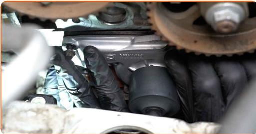
**63** Schrauben Sie die Befestigungen der Wasserpumpe fest. Verwenden Sie Stecknuss Nr. 8. Verwenden Sie einen Drehmomentschlüssel. Ziehen Sie ihn mit 12 Nm Drehmoment fest.
