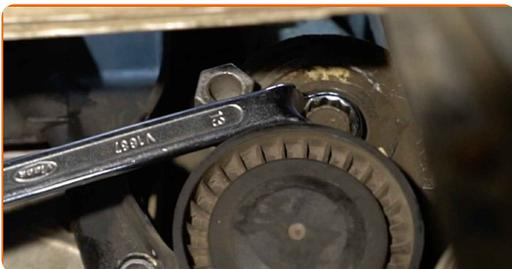
**49** Entfernen Sie die Spannrolle des Keilrippenriemens.
