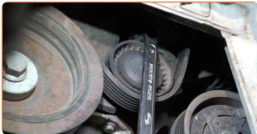
**17** Entfernen Sie den Keilrippenriemen.
