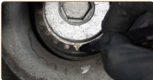
**40** Bauen Sie die Nockenwellenradarretierung anhand der Werksmarkierungen ein. Verwenden Sie einen Motoreinstellwerkzeugssatz.
