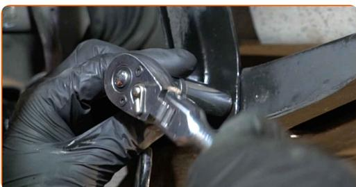
**22** Schrauben Sie die Hilfsrahmenbefestigung ab. Verwenden Sie Stecknuss Nr. 18. Verwenden Sie einen Ratschenschlüssel.
