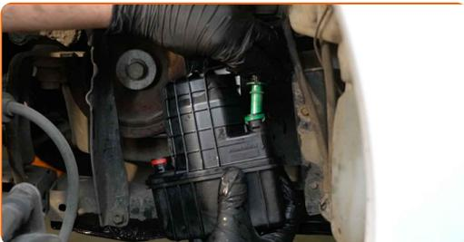
**20** Installieren Sie einen neuen Kraftstofffilter.
