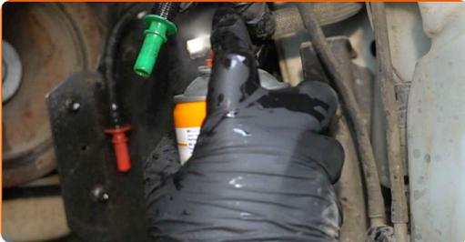
**19** Verbinden Sie die Kraftstoffversorgungsleitungen zum Kraftstofffilter.
