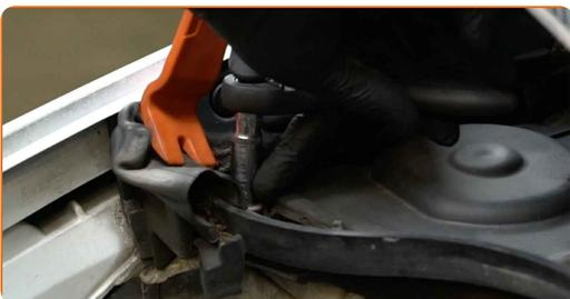
**7** Entfernen Sie die Schutzkappe von der Stoßdämpferstütze.
