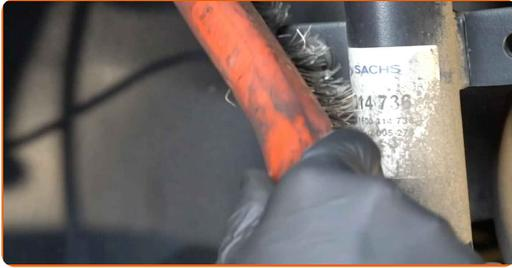
**16** Schrauben Sie das Befestigungselement heraus, das die Druckstange mit dem Federbein verbindet. Verwenden Sie Stecknuss Nr. 16. Verwenden Sie einen Ratschenschlüssel.
