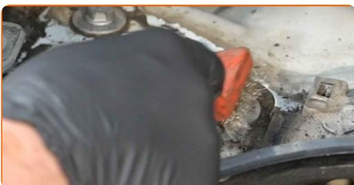
**9** Lösen Sie die oberen Befestigungselemente des Federbeinstützlagers. Verwenden Sie Stecknuss Nr. 13. Verwenden Sie einen Ratschenschlüssel.
