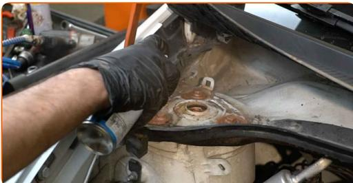
**68** Setzen Sie die Schutzkappe auf die Stoßdämpferstütze.
