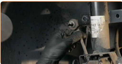
**18** Trennen Sie die ABS Sensorverdrahtung. Benutzen Sie ein Brecheisen.
