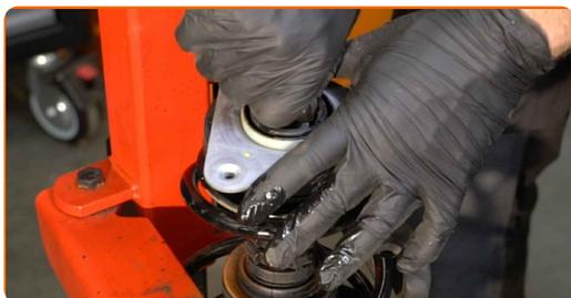
**41** Ziehen Sie die Federbeinkolbenstangenmutter an. Verwenden Sie Stecknuss Nr. 18. Verwenden Sie Inbusschlüssel Nr. H6. Verwenden Sie einen Drehmomentschlüssel. Ziehen Sie ihn mit 62 Nm Drehmoment fest.
