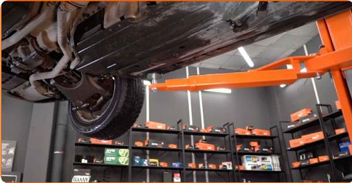
**2** Reinigen Sie die Befestigungen der Kraftstoff-Zuleitungen. Verwenden Sie eine Nylon-Reinigungsbürste. Verwenden Sie Allzweckreinigungsspray.
