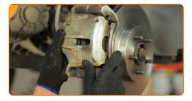
Schrauben Sie die Führungsbolzen hinein.
