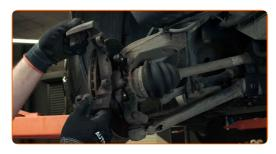
Entfernen Sie die Bremsscheibe.
