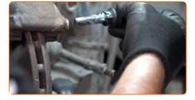
Ziehen Sie die Bremssattelbefestigungen fest. Verwenden Sie Ring-Gabelschlüssel Nr. 19. Verwenden Sie Stecknuss Nr. 13. Verwenden Sie einen Drehmomentschlüssel. Ziehen Sie ihn mit 30 Nm Drehmoment fest.
