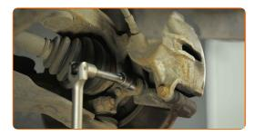
Entfernen Sie die Führungsstifte aus dem Bremssattel.
