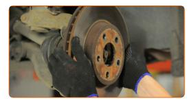
Reinigen Sie die Nabe. Benutzen Sie eine Drahtbürste. Behandeln Sie die Kontaktfläche. Benutzen Sie ein Kupferschmiermittel.
