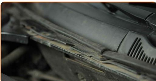
**8** Schrauben Sie die Befestigungen der Windlaufabdeckung an, die sich auf der rechten Seite befindet. Verwenden Sie den Torx T30. Verwenden Sie einen Ratschenschlüssel.
