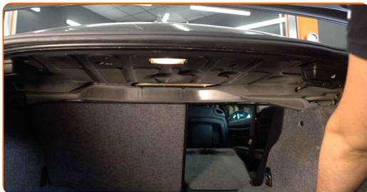
**5** Schrauben Sie das Befestigungselement der zentralen Schutzverkleidung aus Kunststoff heraus. Verwenden Sie einen Lösehebel, um die Clips zu entfernen. Verwenden Sie einen Kreuzschlitzschraubendreher.
