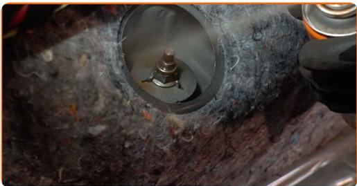
**44** Bringen Sie die Befestigungskappe am oberen Befestigungselement des Stoßdämpfers an.
