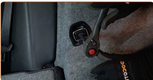
**51** Bringen Sie die Clips der Seitenauskleidung des Kofferraums an.
