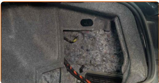
**46** Bringen Sie die zentrale Schutzverkleidung aus Kunststoff an.
