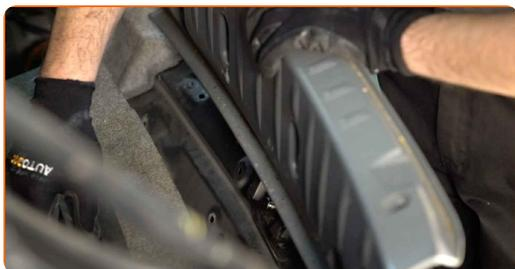
**8** Entfernen Sie die Clips der Seitenauskleidung des Kofferraums. Verwenden Sie einen Lösehebel, um die Clips zu entfernen.
