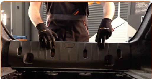
**47** Schrauben Sie das Befestigungselement der zentralen Schutzverkleidung aus Kunststoff ein. Verwenden Sie einen Kreuzschlitzschraubendreher.
