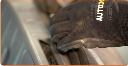
**49** Setzen Sie die untere Kofferraumverkleidung ab.
