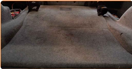
**50** Schrauben Sie das Befestigungselement der Seitenauskleidung des Kofferraums ein. Verwenden Sie den Torx T30. Verwenden Sie einen Ratschenschlüssel.
