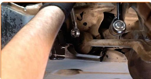
**24** Lösen Sie den hinteren Querlenker vom Achsschenkel. Lösen Sie den vorderen Querlenker vom Achsschenkel.
