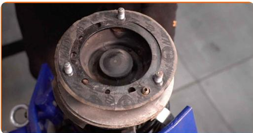
**43** Dekomprimieren Sie die Feder.
