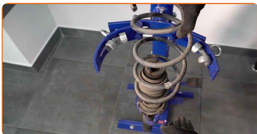
**36** Die Staubkappe des Stoßdämpfers und den Anschlagpuffer entfernen.
