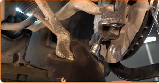
**25** Ziehen Sie den Achsschenkel vom Dämpferbein ab. Verwenden Sie einen Splintentreiber. Benutzen Sie einen Hammer.
