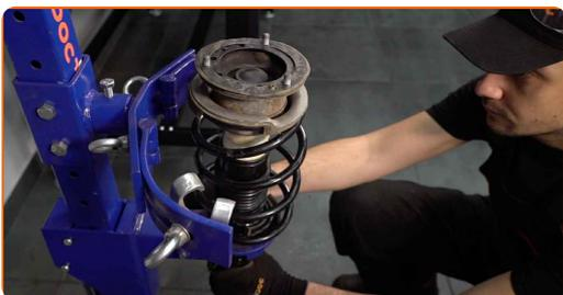
**44** Entfernen Sie das zusammengebaute Federbein.
