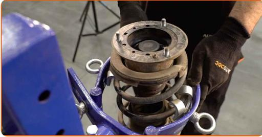
**30** Entfernen Sie die Kappe des Federbeinstützlagers. Benutzen Sie ein Brecheisen.
