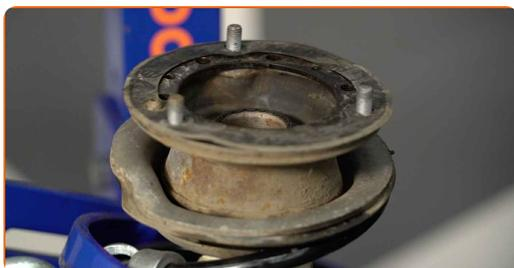
**41** Ziehen Sie die Federbeinkolbenstangenmutter an. Verwenden Sie Stecknuss Nr. 21. Verwenden Sie Inbusschlüssel Nr. H6. Verwenden Sie einen Ratschenschlüssel. Verwenden Sie einen Drehmomentschlüssel. Ziehen Sie ihn mit 64 Nm Drehmoment fest.
