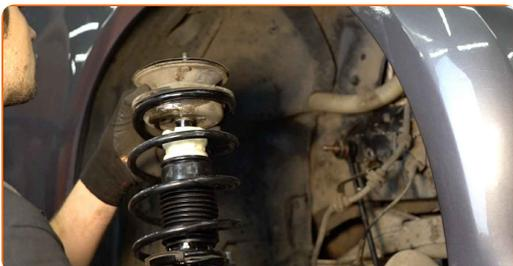
**46** Schrauben Sie die obere Befestigung des Domlagers an. Verwenden Sie Stecknuss Nr. 13. Schrauben Sie diese nicht fest.
