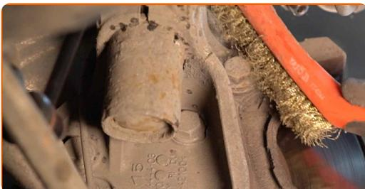
**17** Lösen Sie die Befestigung der Sattelhalterung. Verwenden Sie Stecknuss Nr. 17. Verwenden Sie ein Windeisen.
