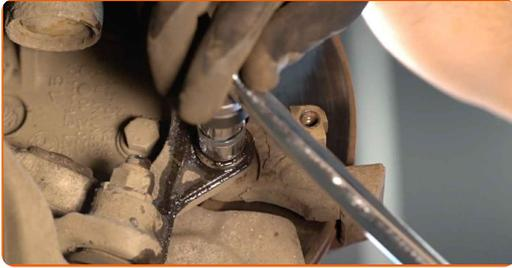
**18** Entfernen Sie die Sattelhalterung.
