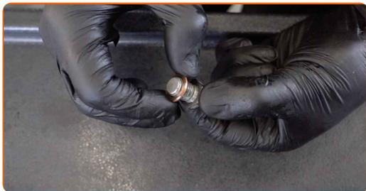
**20** Reinigen Sie den Stecker und setzen Sie einen neuen O-Ring auf ihn.
