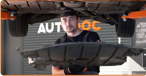
**24** Ziehen Sie die Befestigungen der unteren Ölwanne-Abdeckung fest. Verwenden Sie Stecknuss Nr. 8. Verwenden Sie einen Ratschenschlüssel.
