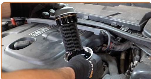
**6** Bedecken Sie das Ölfiltergehäuse mit einem Mikrofasertuch, um zu verhindern, dass Schmutz und Fremdkörper in das System gelangen.
