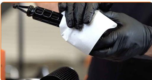
**17** Installieren Sie einen neuen Dichtungsring an seinem Montagesitz auf der Filterabdeckung.
