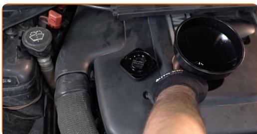
**31** Füllen Sie Öl durch den Einfüllstutzen in den Motor. Erforderliche Menge an Öl: 5.5 l.
