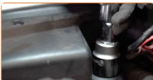
**30** Entfernen Sie die Öleinfüllschraube. Setzen Sie den Trichter ein.
