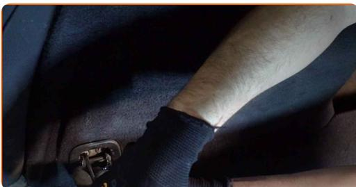
**11** Trennen Sie die Vorderseitenverkleidung des Kofferraum von den oberen Befestigungen. Benutzen Sie ein Brecheisen.
