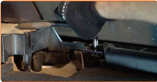
**9.2** Verwenden Sie Stecknuss Nr. 10. Verwenden Sie einen Kreuzschlitzschraubendreher.
