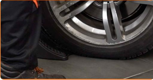
17 Lösen Sie die Radhalterungsschrauben. Verwenden Sie eine Schlagnuss für Felgen # 17.
