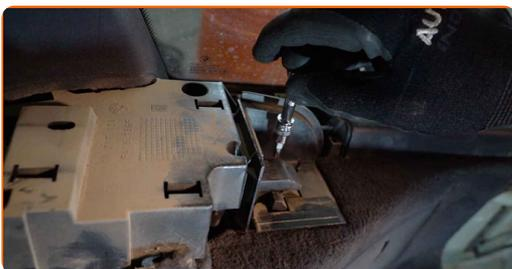
**9.1** Schrauben Sie die Befestigungen des Kofferraum-Lüftungselements heraus.
