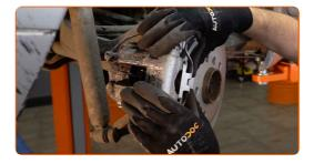
Die Bremsscheibenoberfläche reinigen. Benutzen Sie einen Bremsenreiniger.
