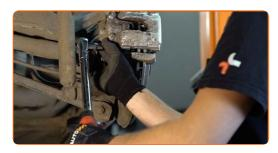
Installieren Sie die Staubschutzkappen der Bremssattel-Führungsstifte.
