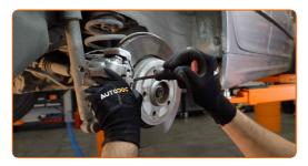
Entfernen Sie den Bremssattel.
