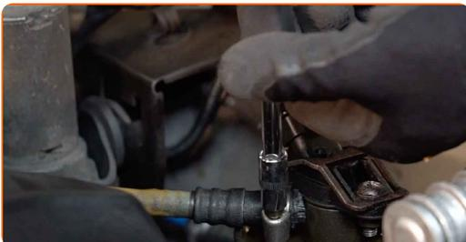
**4** Trennen Sie den Anschluss des Kraftstoffdrucksensors.
