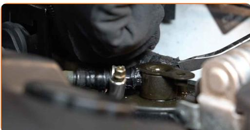
**8** Lösen Sie die Halterung des Kraftstofffilters. Verwenden Sie den Torx T30. Verwenden Sie einen Ratschenschlüssel.
