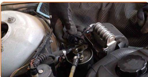
**7** Lösen Sie die Schläuche vom Kraftstofffilter. Benutzen Sie ein Brecheisen.
