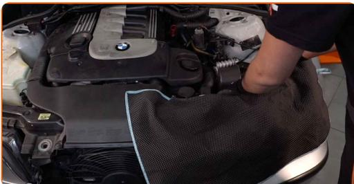
**3** Lockern Sie die Befestigungsklemme der Kraftstofffilterleitung. Verwenden Sie Stecknuss Nr. 7.
