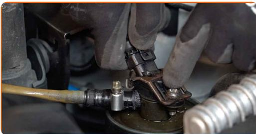
**5** Schrauben Sie das Befestigungselement des Kraftstoffdrucksensors heraus. Verwenden Sie den Torx T30.
