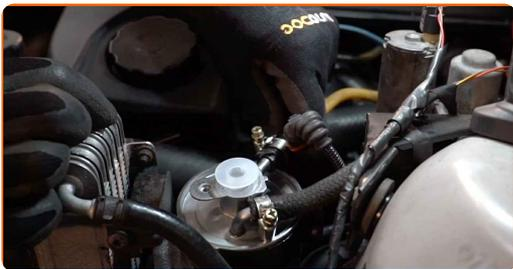
**13** Ziehen Sie die Befestigungsklemme der Kraftstofffilterleitung an. Verwenden Sie Stecknuss Nr. 7.
