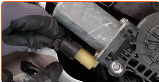
**18** Schrauben Sie die Befestigungen des Fensterhebermoduls ab. Verwenden Sie den Torx T30. Verwenden Sie einen Ratschenschlüssel.
