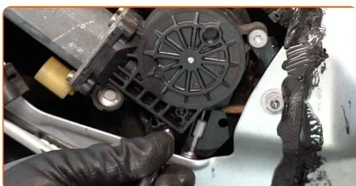
**19** Entfernen Sie das Schaltmodul des elektrischen Fensterhebers.
