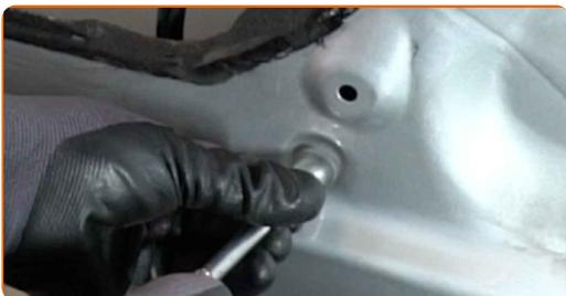
**23** Drücken Sie die Halterung des Fensterheberrmotors zusammen, um ihn zu lösen und abzunehmen. Verwenden Sie eine Rundzange.
