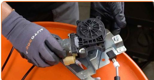
**26** Schrauben Sie die Befestigungen des Fensterhebermoduls fest. Verwenden Sie den Torx T30. Verwenden Sie einen Drehmomentschlüssel. Ziehen Sie ihn mit 11 Nm Drehmoment fest.
