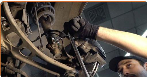
15 Schrauben Sie die Kugelgelenkbefestigung vom Achsschenkel ab. Verwenden Sie Ring-Gabelschlüssel Nr. 19.
