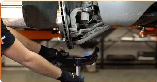
21 Lösen Sie das untere Befestigungselement, dass das Federbein mit dem Achsschenkel verbindet. Verwenden Sie eine spezielle Schraubnuss, um den Stoßdämpfer zu entfernen.
