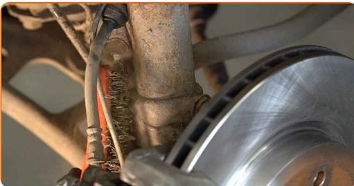
**14** Schrauben Sie das untere Befestigungselement ab, dass das Federbein mit dem Achsschenkel verbindet. Verwenden Sie Stecknuss Nr. 18. Verwenden Sie ein Windeisen.
