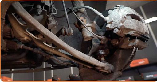
20 Stützen Sie die Achsschenkel auf. Benutzen Sie einen hydraulischen Getriebeheber.
