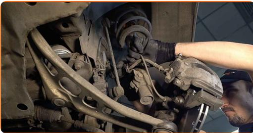
**13** Die Befestigungselemente, die das Federbein mit dem Achsschenkel verbinden, reinigen. Reinigen Sie das Verbindungselement, welches das Kugelgelenk mit dem Achsschenkel verbindet. Benutzen Sie eine Drahtbürste. Benutzen Sie WD-40-Spray.
