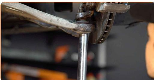
17 Trennen Sie das Kugelgelenk vom Achsschenkel. Verwenden Sie einen Kugelgelenkabzieher.
