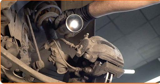
**12** Lösen Sie die Verdrahtung und den Bremsschlauch aus der Halterung am Federbein.
