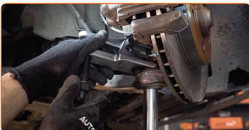
18 Senken Sie den hydraulischen Getriebeheber um 10–15 cm.
