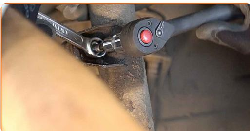
**11** Behandeln Sie den Haltebügel, der den Bremsschlauch und den Kabelbaum fixiert. Benutzen Sie WD-40-Spray.
